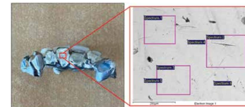
Slika 2: Dentalni most od dentalne legure AUOPAL SE, uklonjen nakon 30 godina upotrebe, sa označenom lokacijom napravljene mikrohemispske analize.
